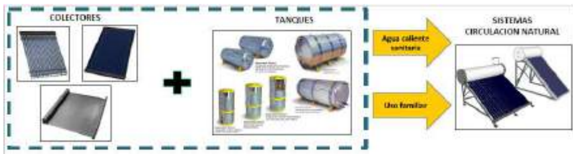
Figura 9. Energía solar térmica: Colectores solares que sumados a tanques constituyen sistemas de circulación natural para la provisión de ACS de uso familiar 10 .
