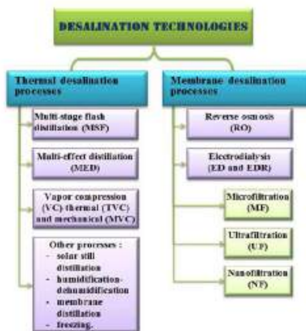
Figura 26 – Tecnologías de desalinización de agua
