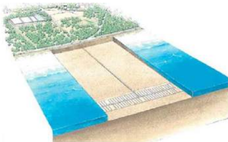
Figura 79 – Toma de agua mediante galerías de infiltración
