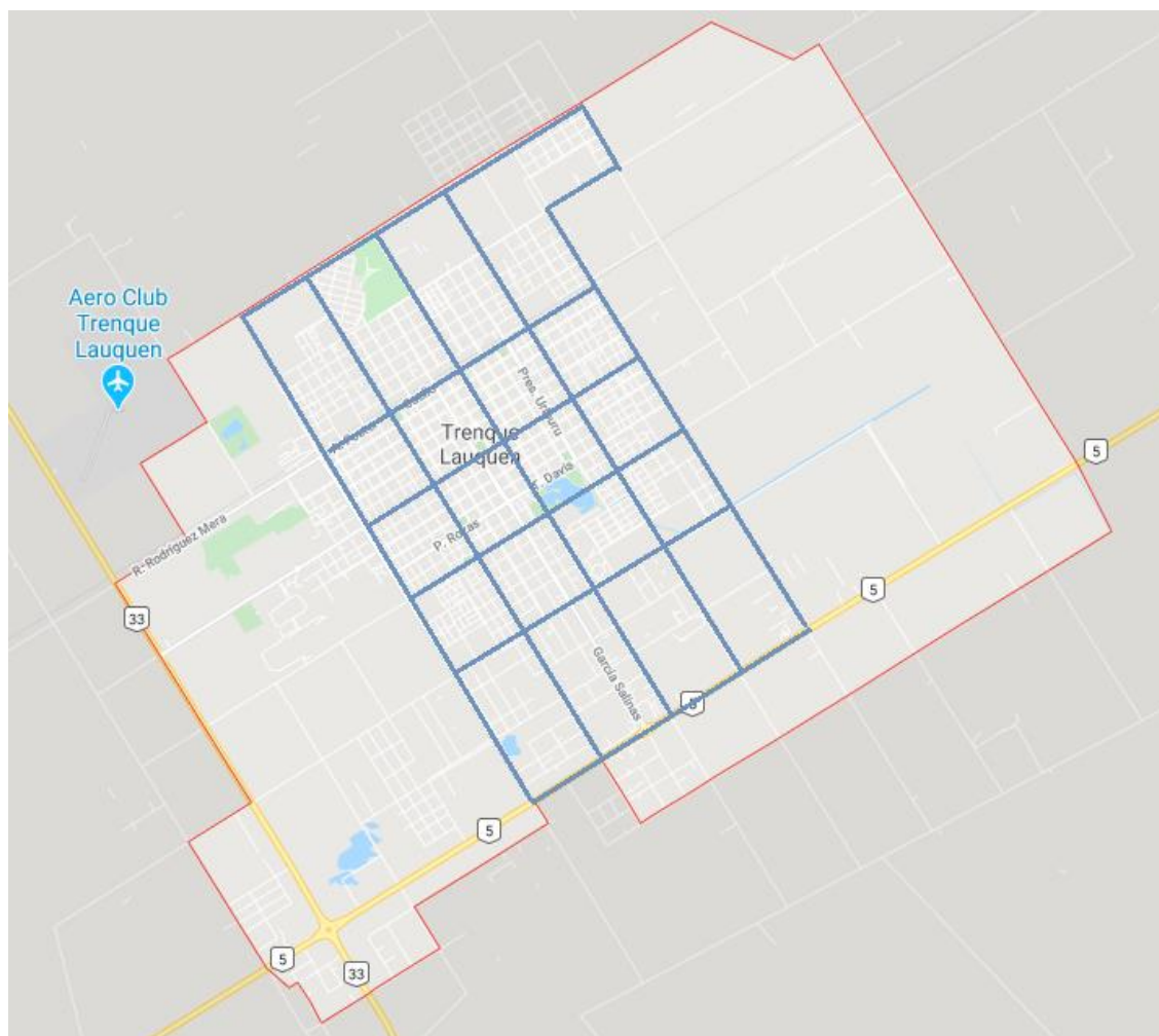
Figura 63. Esquema sugerido para la delimitación en la ciudad de las zonas de generación distribuida. Para la configuración sugerida se tuvo en cuenta las zonas de mayor edificación del municipio. Elaboración propia.
