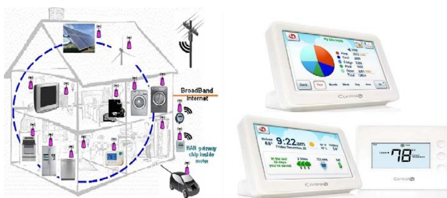
Figura 35. Esquemas de monitoreo de consumos de energía con integración de todos los electrodomésticos al sistema. Fuente: Ehrhardt-Martinez (2010).
