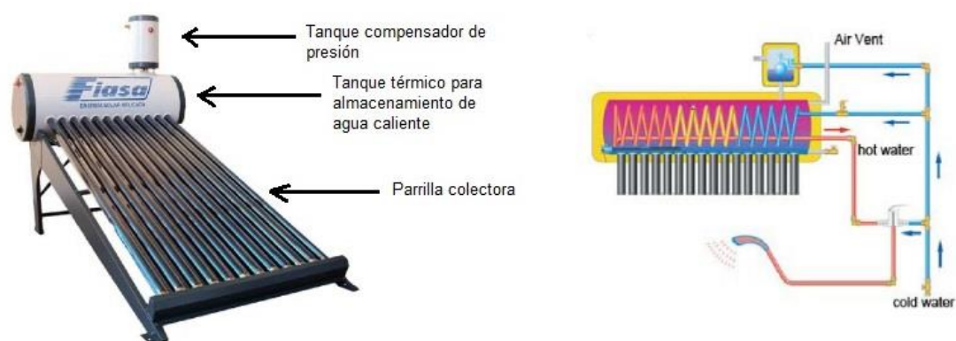
Figura 36. En la imagen izquierda puede observarse un termo-tanque o colector solar comercial. Este equipo se coloca en general en los techos de las viviendas haciendo que el sol al calentar las varillas de un material absorbente, transmita dicho flujo al interior del tanque y caliente el agua en su interior. En la imagen derecha se observa un esquema que indica como fluye el calor en las distintas etapas del equipo. Fuente FIASA
