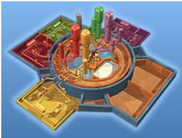
Figura A4-18: EPR Areva los cuatro sistemas de seguridad emplazados en cuatro edificios distintos rodeando al reactor para evitar causas comunes de falla.
