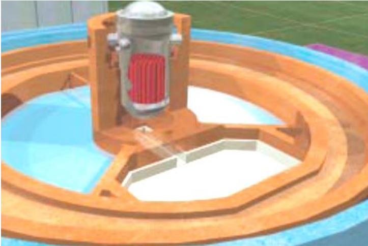
Figura A4-20: Encaso que el núcleo se funda los desechos se juntan en un pozo especialmente dedicado
