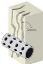
**Agua+propante:** Agua y propante es inyectado a alta presión, creando grietas que se mantienen abiertas por acción del propante.
