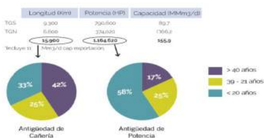
Gráfico 40: Antigüedad de las instalaciones ya instaladas en Argentina.
